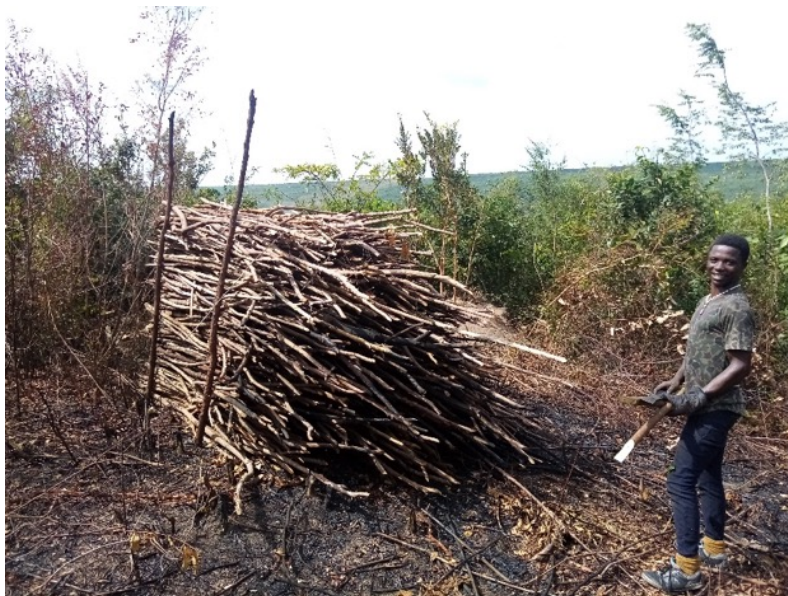
Figure 21 : Meule en cours de construction dans la province du Kongo Central avec du bois issu d'une jeune jachère (Photo : Dubiez, 2021)
