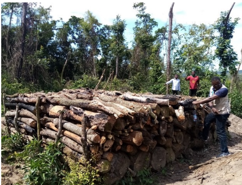
Figure 20 : Meule en cours de construction dans la province du Kwango (Photo : Dubiez, 2021)
